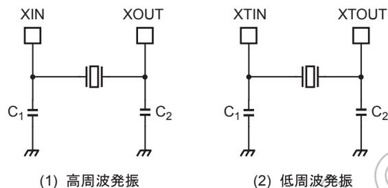
注 1) 弊社マイクロコントローラの発振子として、(株)村田製作所のセラミック発振子を推奨します。
