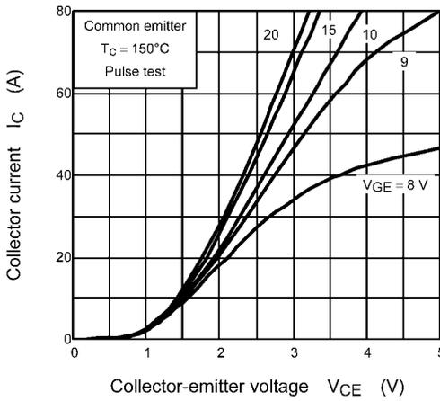
**Fig. 8.3  $I_C - V_{CE}$**
