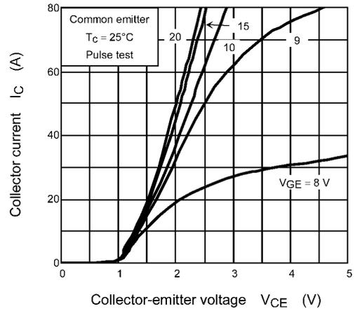
**Fig. 8.2  $I_C - V_{CE}$**
