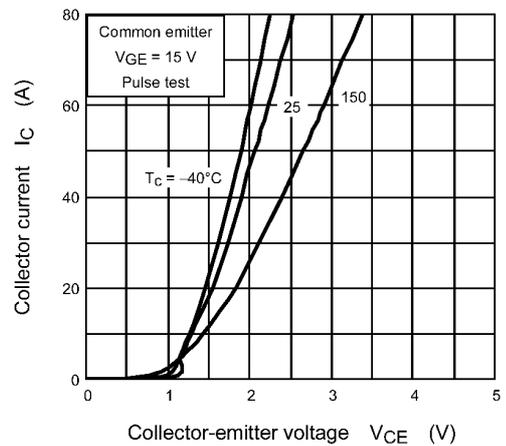
**Fig. 8.4  $I_C - V_{CE}$**
