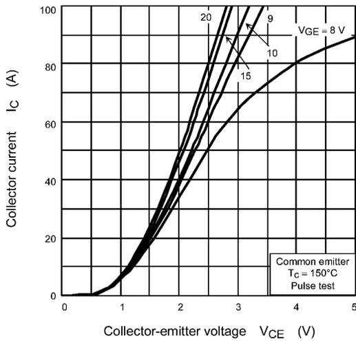
**Fig. 8.3  $I_C - V_{CE}$**
