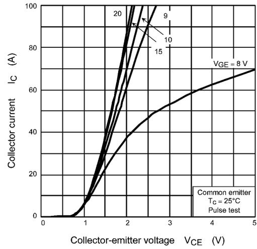
**Fig. 8.2  $I_C - V_{CE}$**
