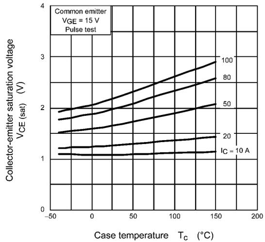
**Fig. 8.4  $V_{CE(sat)} - T_C$**
