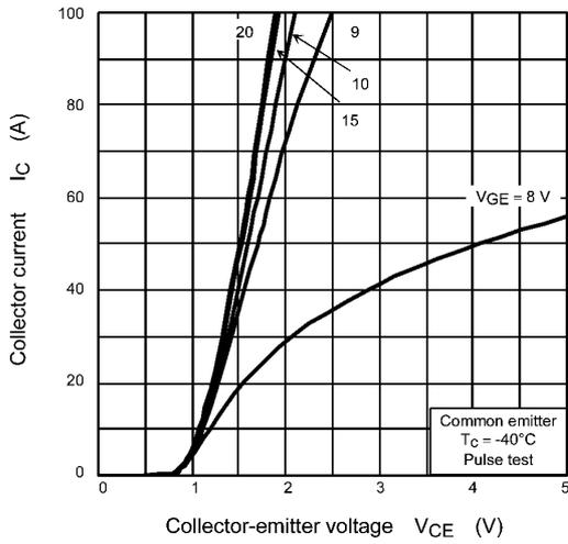
**Fig. 8.1  $I_C - V_{CE}$**
