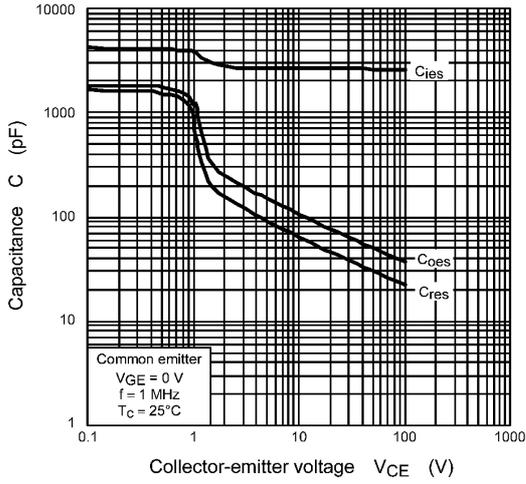
**Fig. 8.7 C -  $V_{CE}$**
