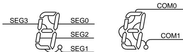
図 15-7 COM, SEG 端子接続例
