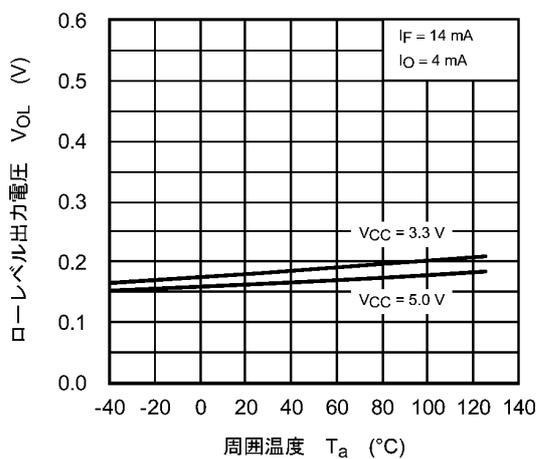
図 12.2.3  $V_{OL} - T_a$
