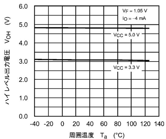
図 12.2.4  $V_{OH} - T_a$
