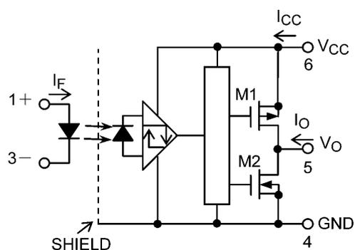
注: 6ピンと4ピンの間にバイパス用のコンデンサ0.1  $\mu\text{F}$ を付ける必要があります。
