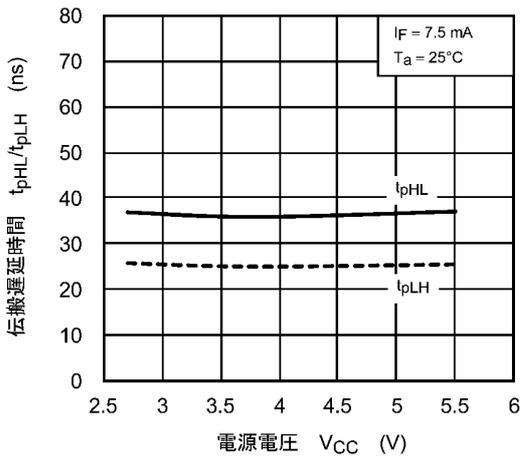
図 12.2.17  $t_{pHL}/t_{pLH} - V_{CC}$
