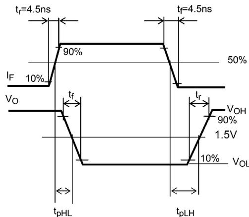
図 12.1.5 伝搬遅延時間測定回路, 波形
