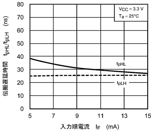
図 12.2.13  $t_{pHL}/t_{pLH} - I_F$
