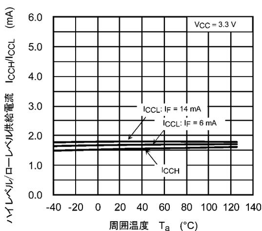
図 12.2.5  $I_{CCH}/I_{CCL} - T_a$
