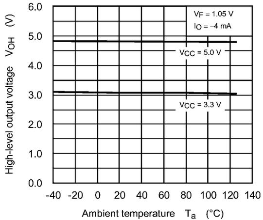
**Fig. 12.2.4  $V_{OH} - T_a$**
