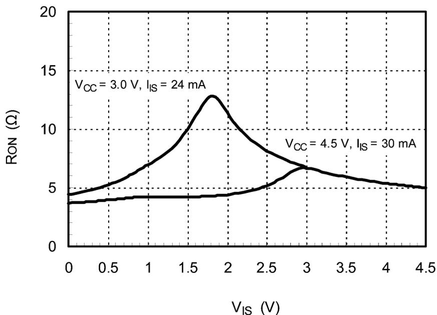
図 13.1  $R_{ON} - V_{IS}$  (標準) ( $T_a = 25^\circ\text{C}$ )
