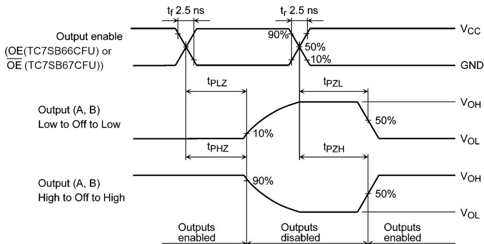
図11.2.2 AC電気的特性測定波形  $t_{PLZ}$ ,  $t_{PHZ}$ ,  $t_{PZL}$ ,  $t_{PZH}$
