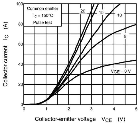
**Fig. 8.3  $I_C - V_{CE}$**
