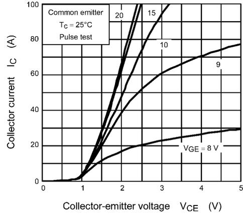
**Fig. 8.2  $I_C - V_{CE}$**
