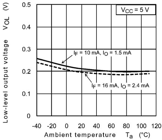
Fig. 12.2.15  $V_{OL} - T_a$
