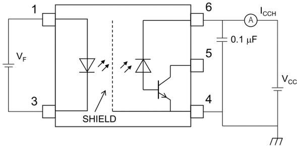
Fig. 12.1.3  $I_{CCH}$  Test Circuit
