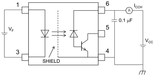
Fig. 12.1.3  $I_{CCH}$  Test Circuit
