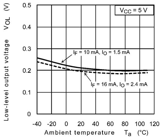
Fig. 12.2.15  $V_{OL} - T_a$
