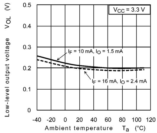
Fig. 12.2.16  $V_{OL} - T_a$
