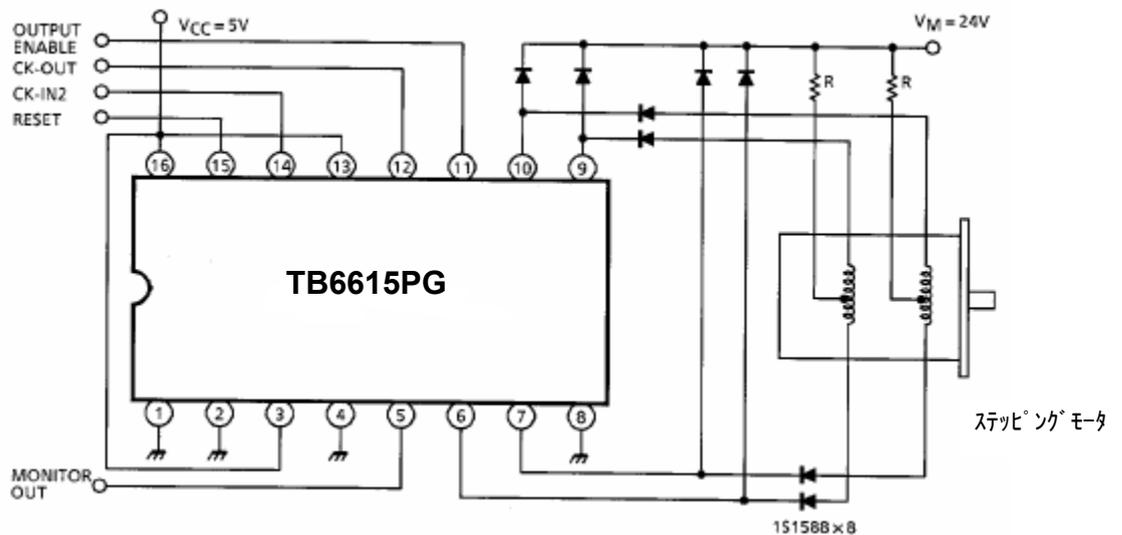
(注)：出力間ショートおよび出力の天絡、地絡時にICの破壊の恐れが有りますので、出力ライン、VCC (VM, VS, VEE)、GNDラインの設計は十分注意してください。
