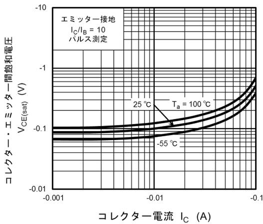
図 7.3  $V_{CE(sat)} - I_C$
