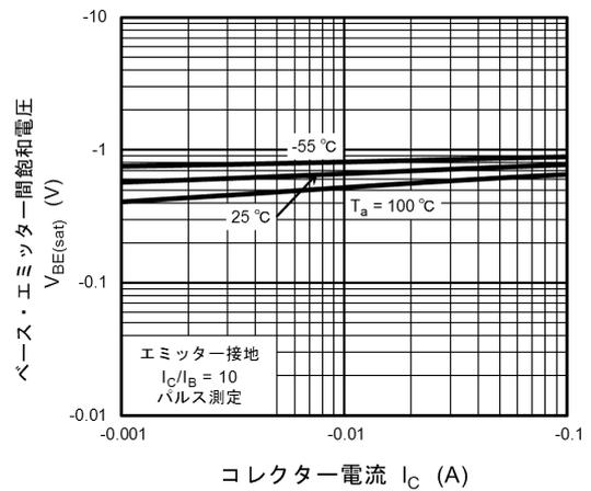
図 7.4  $V_{BE(sat)} - I_C$
