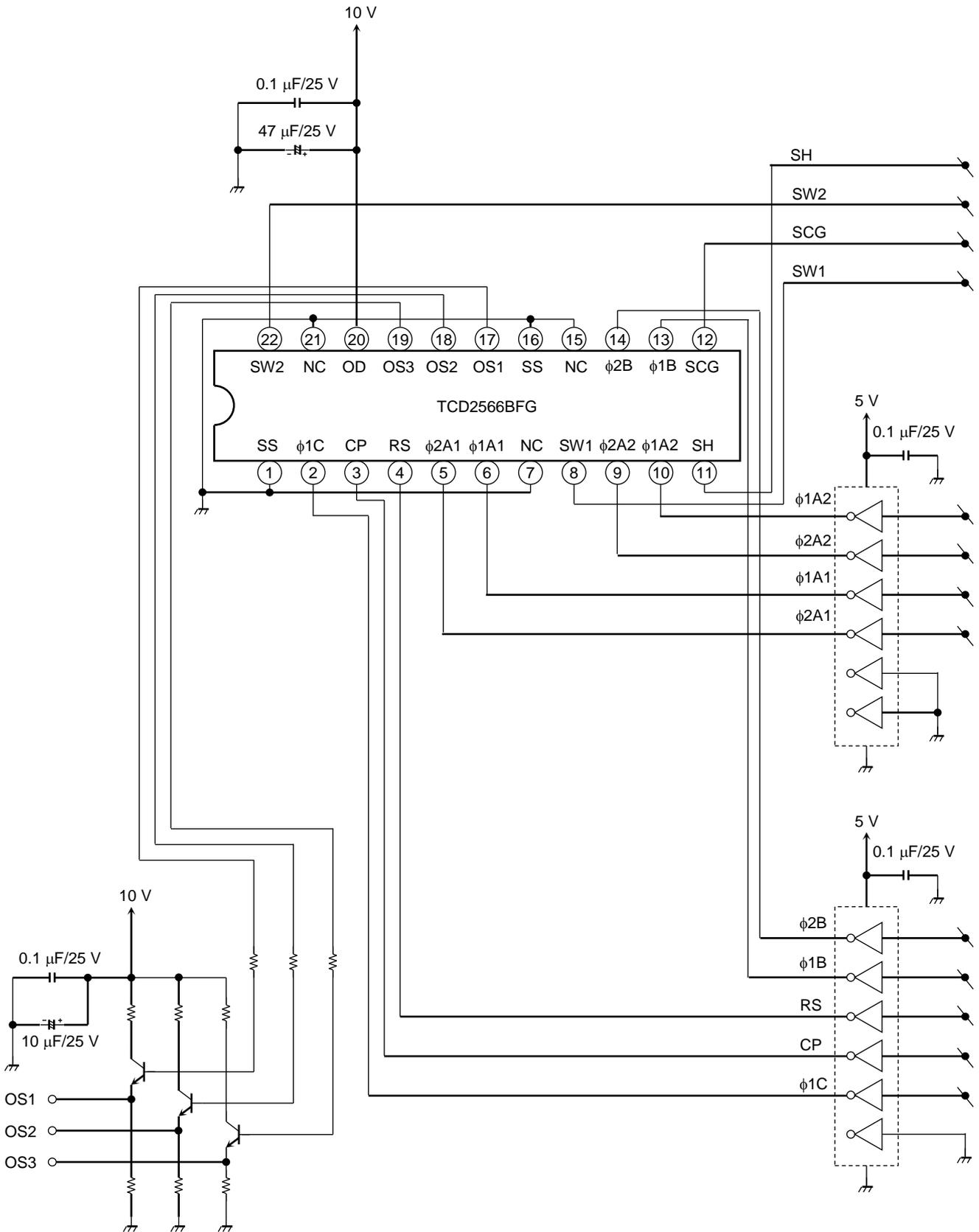
周辺回路例 ( $f_{\phi} = 25 \sim 35 \text{ MHz}$ )
