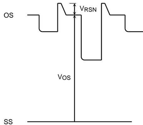
注 9: ランダムノイズは暗状態での隣接する有効画素 2 ビット間の出力レベル差の標準偏差値にて定義します。
