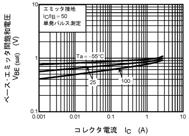
図 7.4  $V_{BE(sat)} - I_C$
