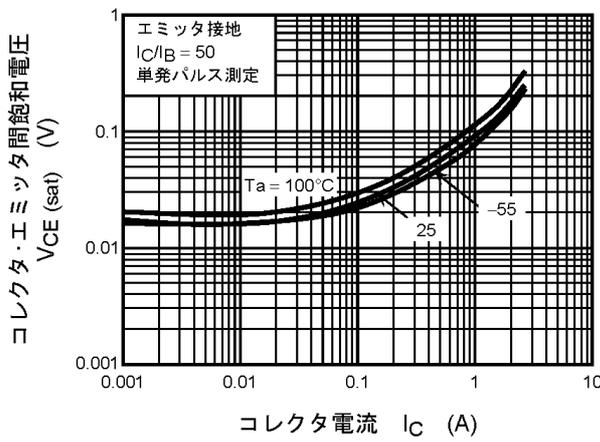
図 7.3  $V_{CE(sat)} - I_C$
