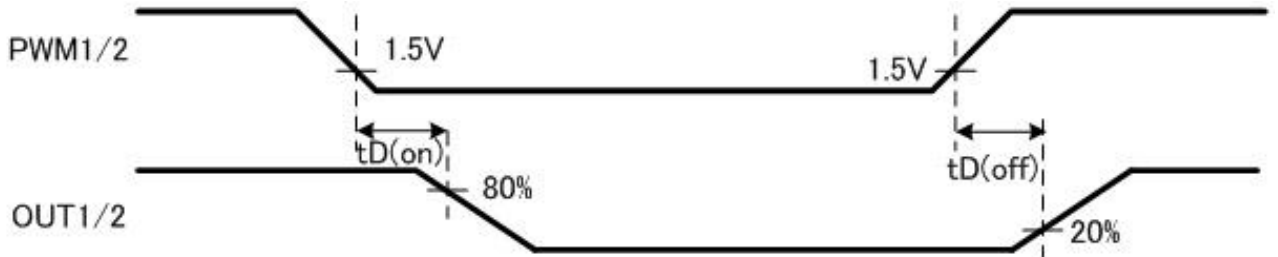
図 10.2 ドライバー出力遅延時間
