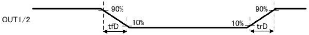
図 10.1 ドライバー出力スルーレート(SR)
