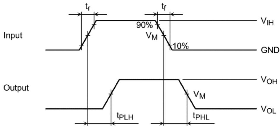
図 11.6.1  $t_{PLH}$ ,  $t_{PHL}$
