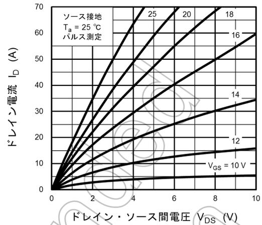
図 8.2  $I_D - V_{DS}$
