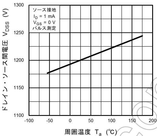
図 8.9  $V_{DS} - T_a$
