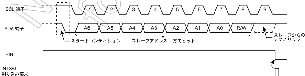
図 16-9 スタートコンディションとスレーブアドレスの発生
