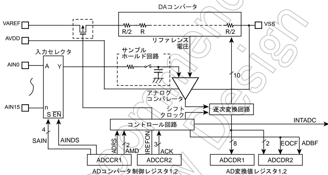
注) AD コンバータを使用する前に、アナログ入力と兼用の I/O ポートレジスタを適切な値に設定してください。詳しくは、I/O ポートの項を参照してください。
