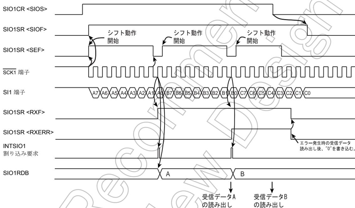
図 14-12 受信モードエラー処理の例
