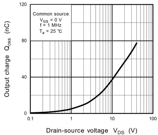
**Fig. 8.12**  $Q_{oss} - V_{DS}$
