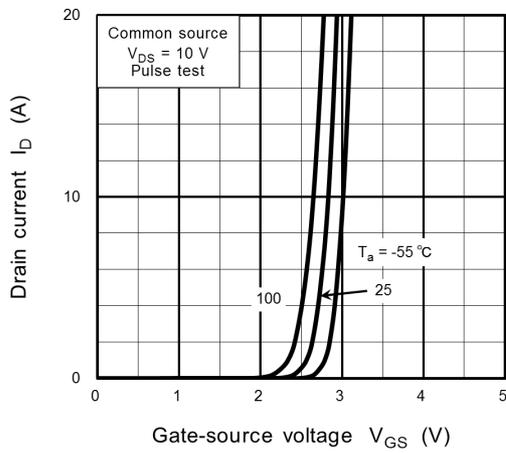
**Fig. 8.3  $I_D - V_{GS}$**
