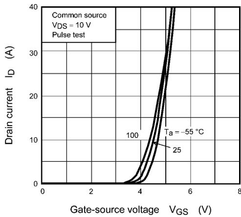
Fig. 8.3  $I_D - V_{GS}$
