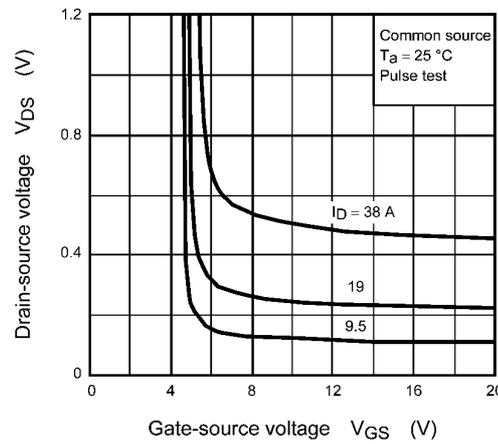
Fig. 8.4  $V_{DS} - V_{GS}$
