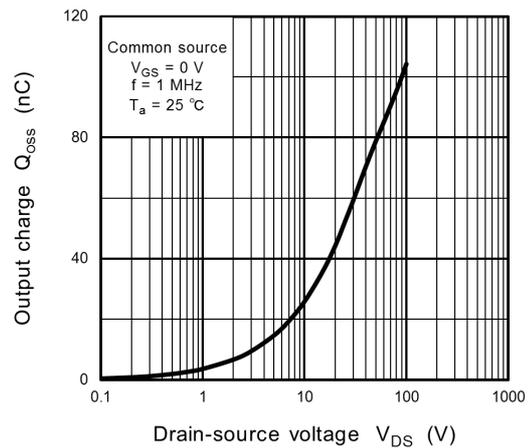
**Fig. 8.12**  $Q_{oss} - V_{DS}$
