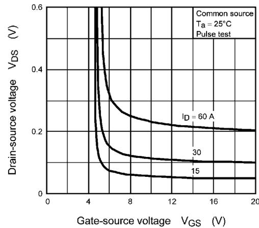
Fig. 8.4  $V_{DS} - V_{GS}$
