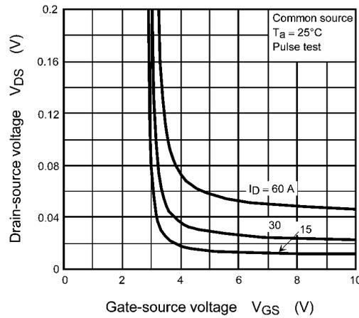
**Fig. 8.4**  $V_{DS} - V_{GS}$
