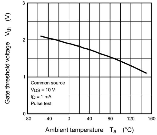
Fig. 8.8  $V_{th} - T_a$
