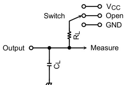
Fig. 11.8.1 AC Test Circuit
