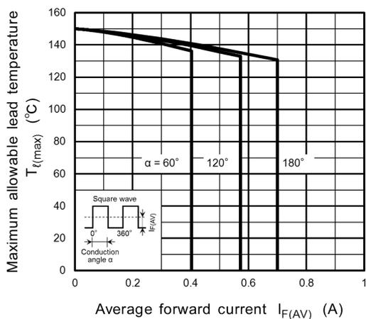
**Fig. 10.5  $T_{\ell(max)} - I_{F(AV)}$**
