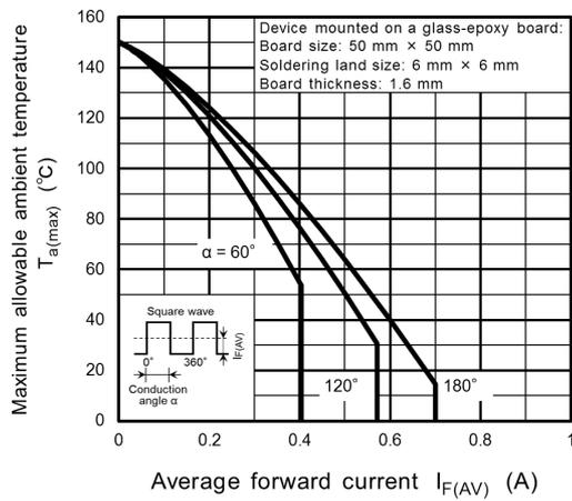
**Fig. 10.4  $T_{a(max)} - I_{F(AV)}$**
