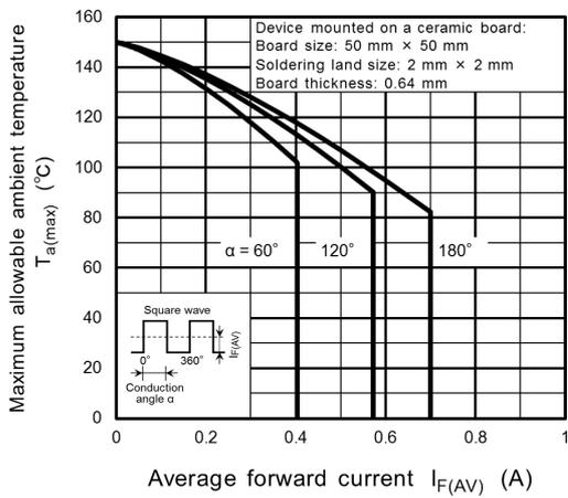
**Fig. 10.3  $T_{a(max)} - I_{F(AV)}$**
