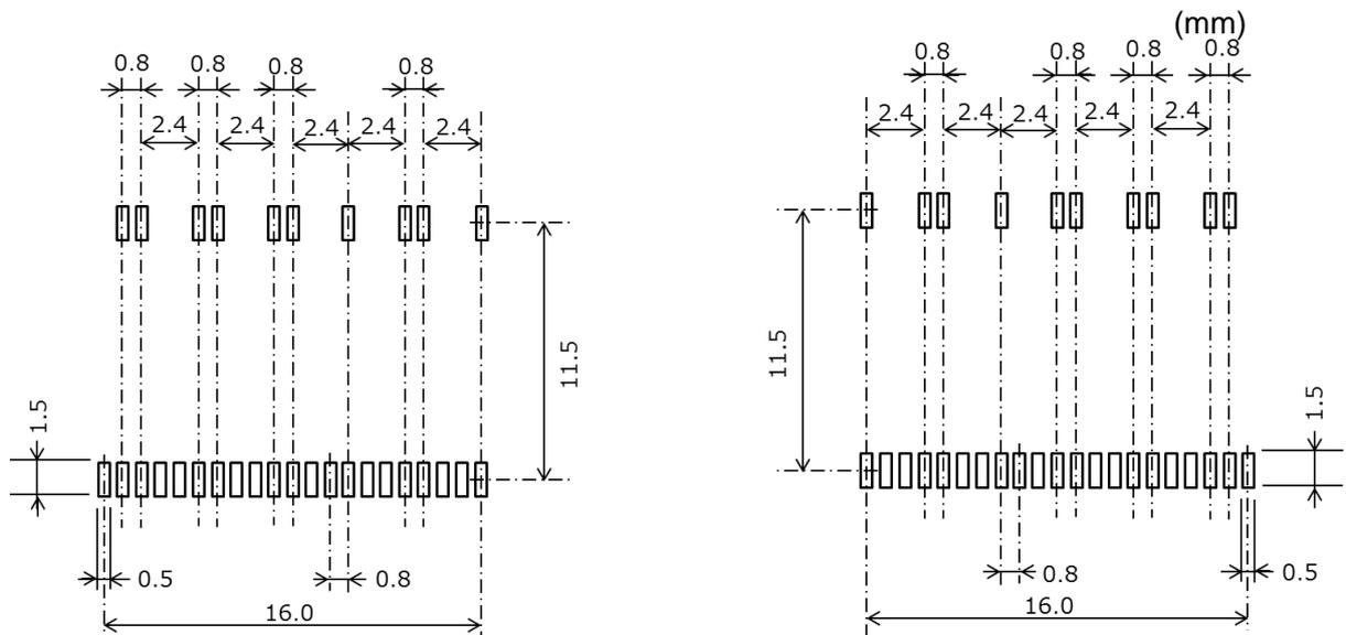
Figure 5 P-HSSOP31-0918-0.80-001 pad dimensions      Figure 6 P-HSSOP31-0918-0.80-002 pad imensions
