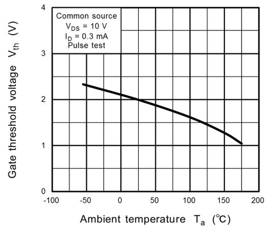
**Fig. 8.12  $V_{th} - T_a$**
