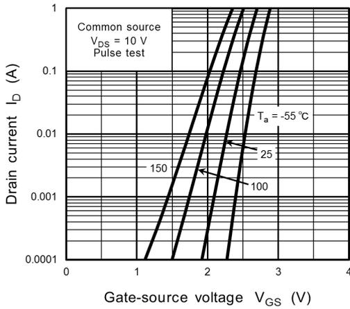
**Fig. 8.7  $I_D - V_{GS}$**
