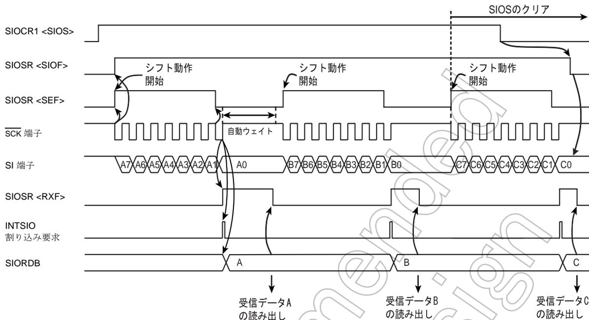
図 10-10 内部クロック、MSB 受信の例
