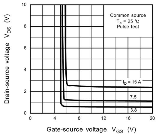
Fig. 8.4  $V_{DS} - V_{GS}$
