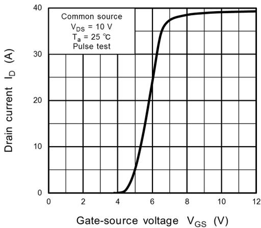
Fig. 8.3  $I_D - V_{GS}$
