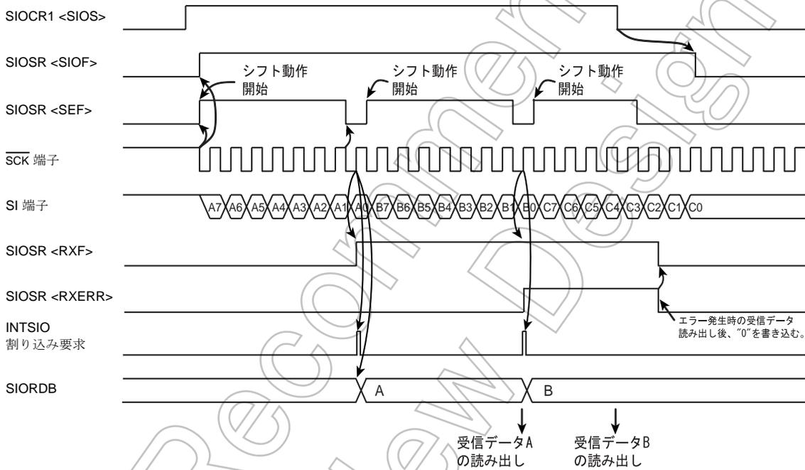
図 10-12 受信モードエラー処理の例
