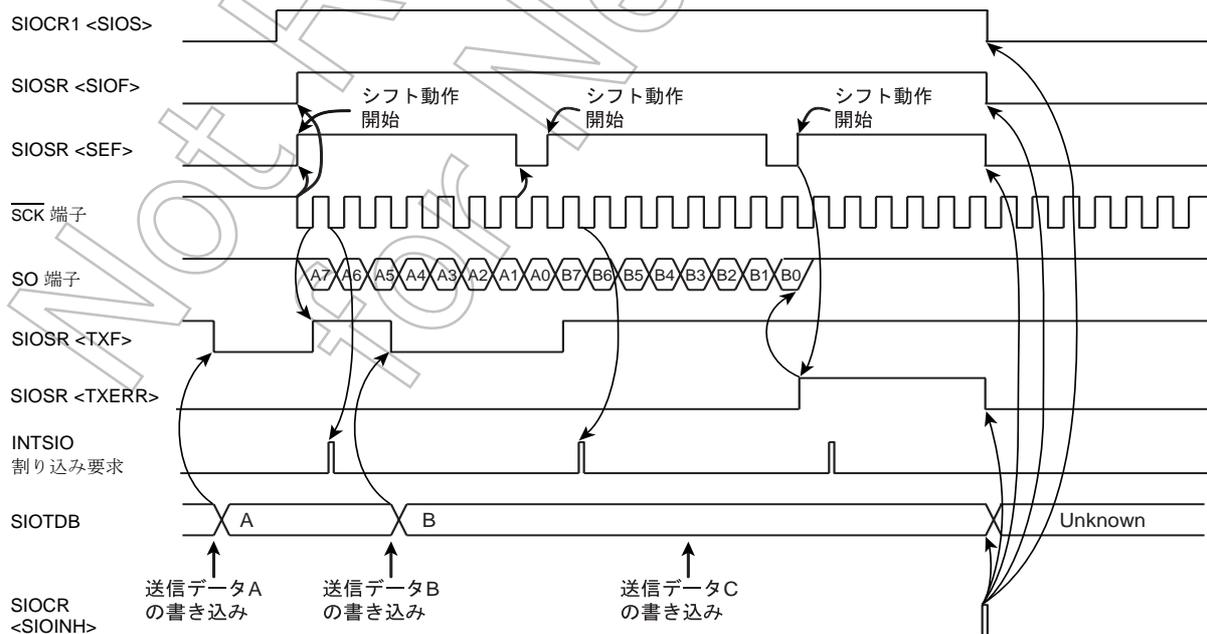
図 10-9 送信モードエラー処理の例
