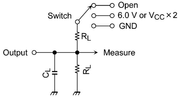
図 13.1 AC電気的特性測定回路
