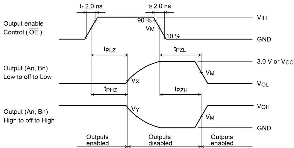
図 14.2 t<sub>PLZ</sub>, t<sub>PHZ</sub>, t<sub>PZL</sub>, t<sub>PZH</sub>
