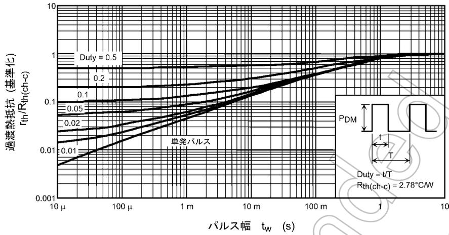
図 8.13  $r_{th}/R_{th(ch-c)} - t_w$
