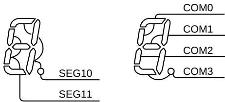
図 15-5 COM, SEG 端子接続例 (1/4 デューティ)
