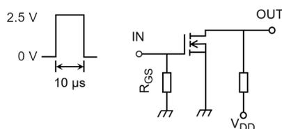
スイッチング時間の測定回路
