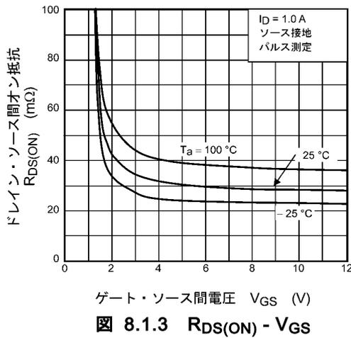
図 8.1.3  $R_{DS(ON)} - V_{GS}$
