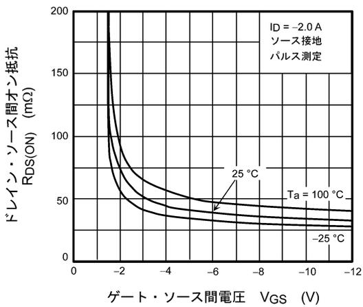
図 8.2.3  $R_{DS(ON)} - V_{GS}$
