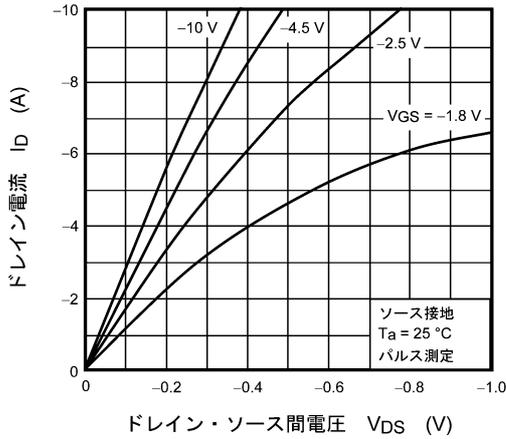
図 8.2.1  $I_D - V_{DS}$
