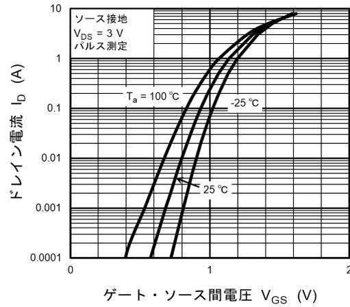
図 8.1.2  $I_D - V_{GS}$
