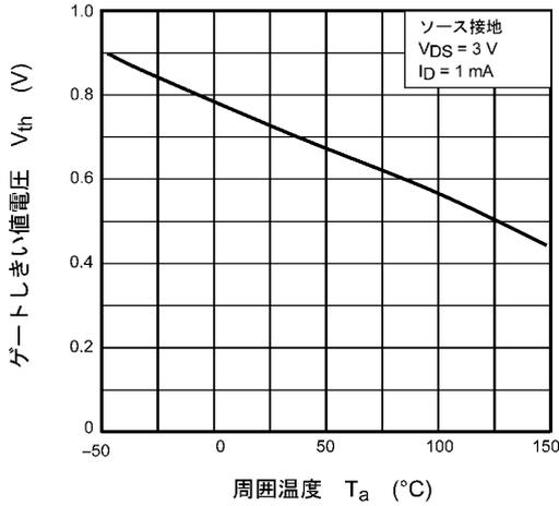
図 8.1.7  $V_{th} - T_a$
