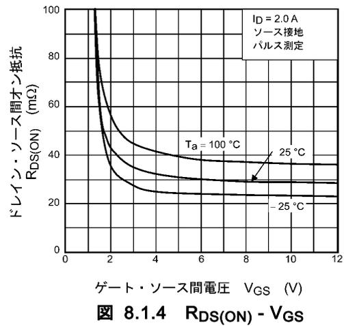
図 8.1.4  $R_{DS(ON)} - V_{GS}$
