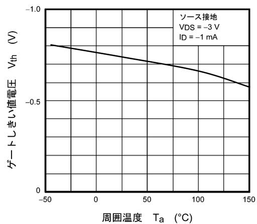
図 8.2.6  $V_{th} - T_a$
