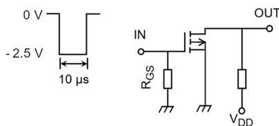
スイッチング時間の測定回路
