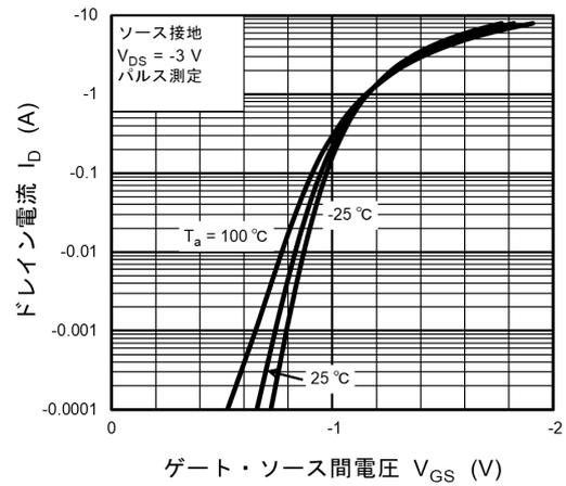
図 8.2.2  $I_D - V_{GS}$
