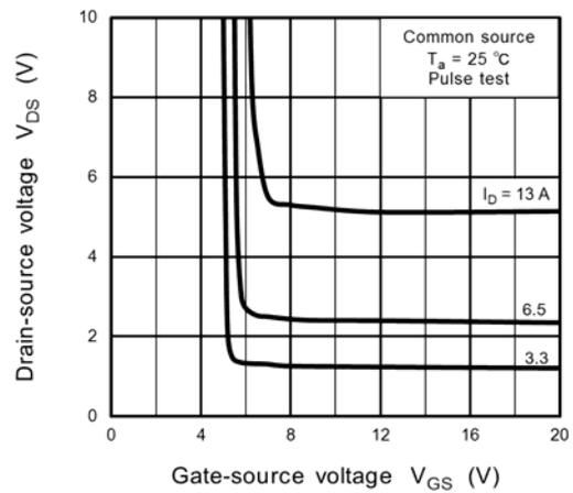
Fig. 8.4  $V_{DS} - V_{GS}$
