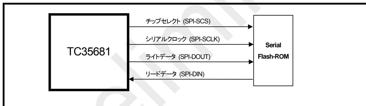
図 4-10 SPI インタフェースによる Serial Flash-ROM 接続例
