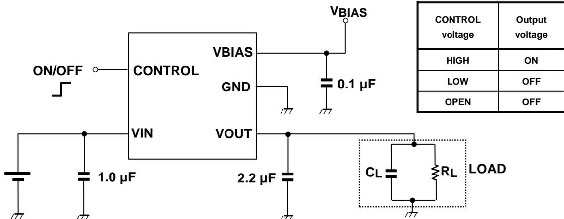
上図にロードドロップアウトレギュレーターの使用回路例を示します。VIN、VOUT および VBIAS 端子には安定動作のためコンデンサーを接続してください。(セラミックコンデンサーの使用が可能です。)
