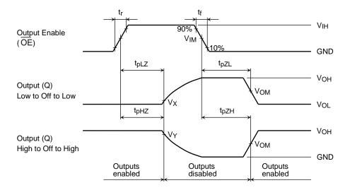
Figure 3  $t_{\text{pLZ}},\,t_{\text{pHZ}},\,t_{\text{pZL}},\,t_{\text{pZH}}$
