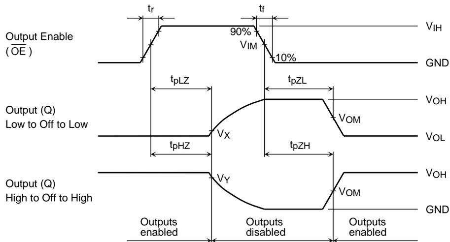
図 3  $t_{pLZ}$ ,  $t_{pHZ}$ ,  $t_{pZL}$ ,  $t_{pZH}$
