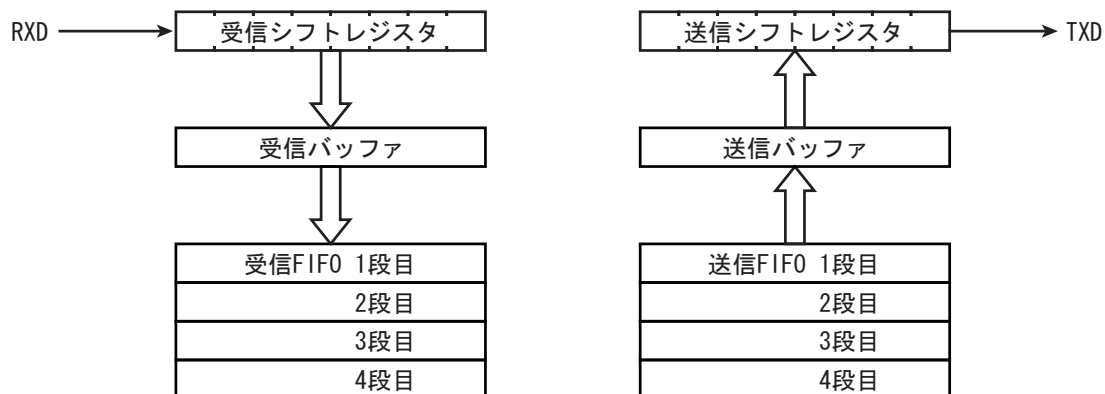
図 10-3 バッファと FIFO の構成
