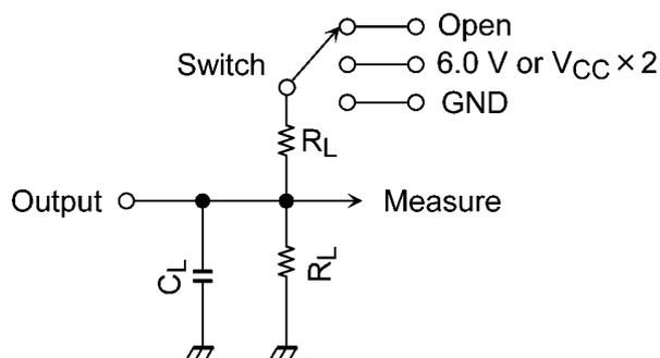
図 12.1 AC電気的特性測定回路
