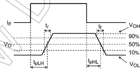
図 13.1.7 伝搬遅延時間測定回路, 波形
