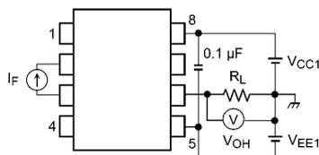
図 13.1.3 V<sub>OH</sub>測定回路
