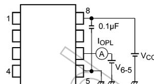
図 13.1.2 I<sub>OL</sub>測定回路
