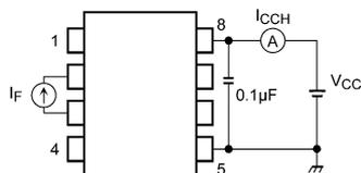
図 13.1.5 I<sub>CCH</sub>測定回路
