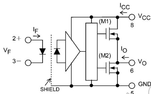
注: 8ピンと5ピンの間にバイパス用のコンデンサ0.1  $\mu$ Fを付ける必要があります。
