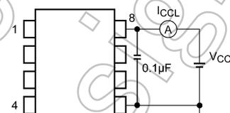
図 13.1.6 I<sub>CCL</sub>測定回路
