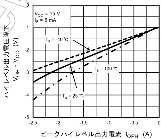
図 13.2.12  $(V_{OH} - V_{CC}) - I_{oPH}$
