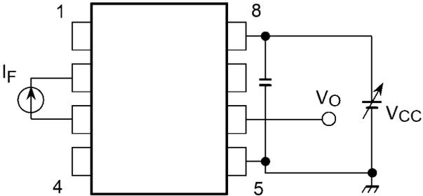
图 13.1.9 V<sub>CC</sub>-V<sub>O</sub>(VUVLO)測定回路
