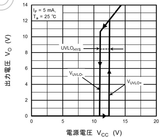
図 13.2.6  $V_O(V_{UVLO}) - V_{CC}$
