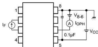
図 13.1.1 I<sub>OPH</sub>測定回路
