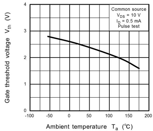
**Fig. 8.12  $V_{th} - T_a$**
