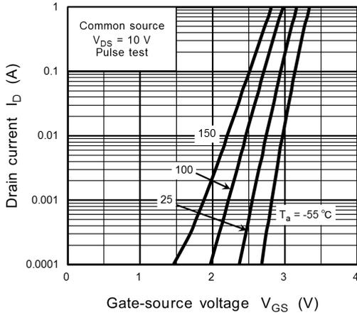
**Fig. 8.7  $I_D - V_{GS}$**
