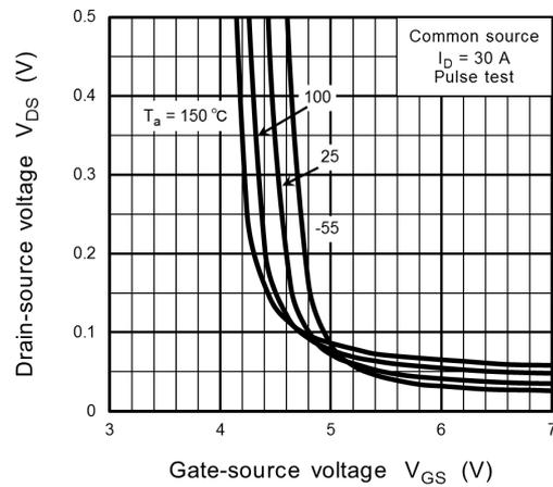
Fig. 8.4  $V_{DS} - V_{GS}$
