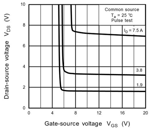
**Fig. 8.4**  $V_{DS} - V_{GS}$
