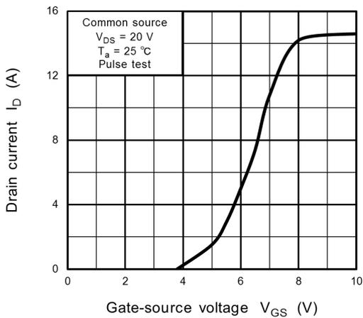
**Fig. 8.3**  $I_D - V_{GS}$
