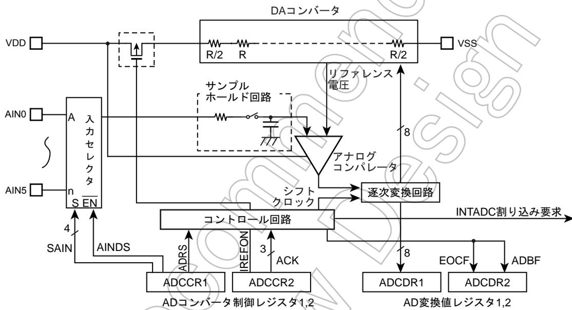
図 12-1 8 ビット AD コンバータ
