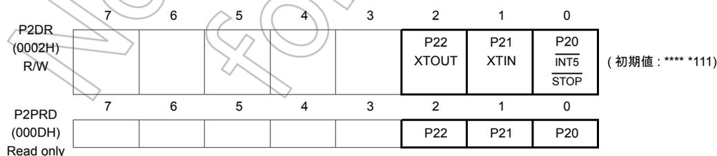
注) P20 端子は  $\overline{\text{STOP}}$  端子と兼用のため、STOP モードに入ると OUTEN の状態にかかわらず、出力は High-Z 状態となります。
