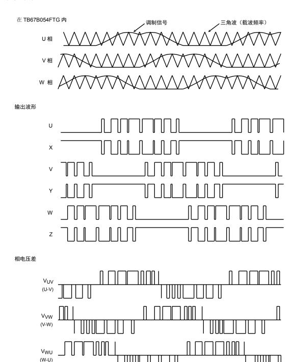
在正弦波驱动模式下,调制信号幅度随 Vsp 电压而变化,而电机速度则随输出波形的导通占空比而变化(参见第 14 页的正弦波驱动模式图)
