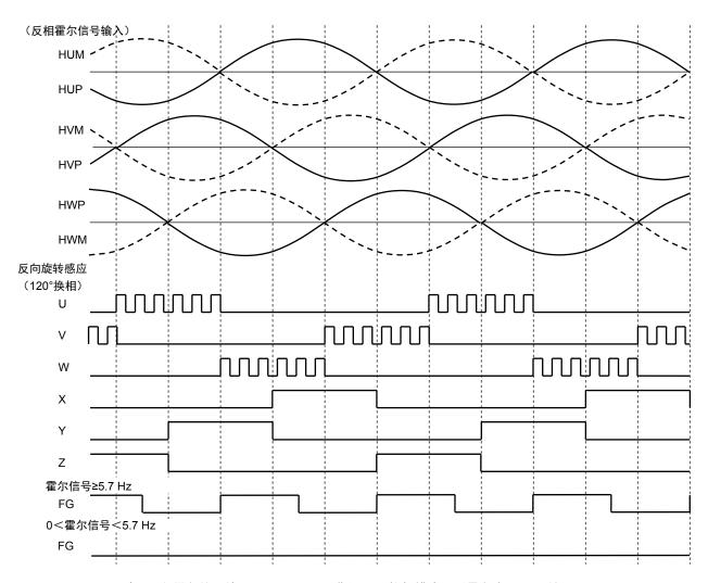
\*: CW/CCW=L 时, 反向霍尔信号使 TB67B054FTG 进入 120°换相模式, 引导角为 0°(反转)。
