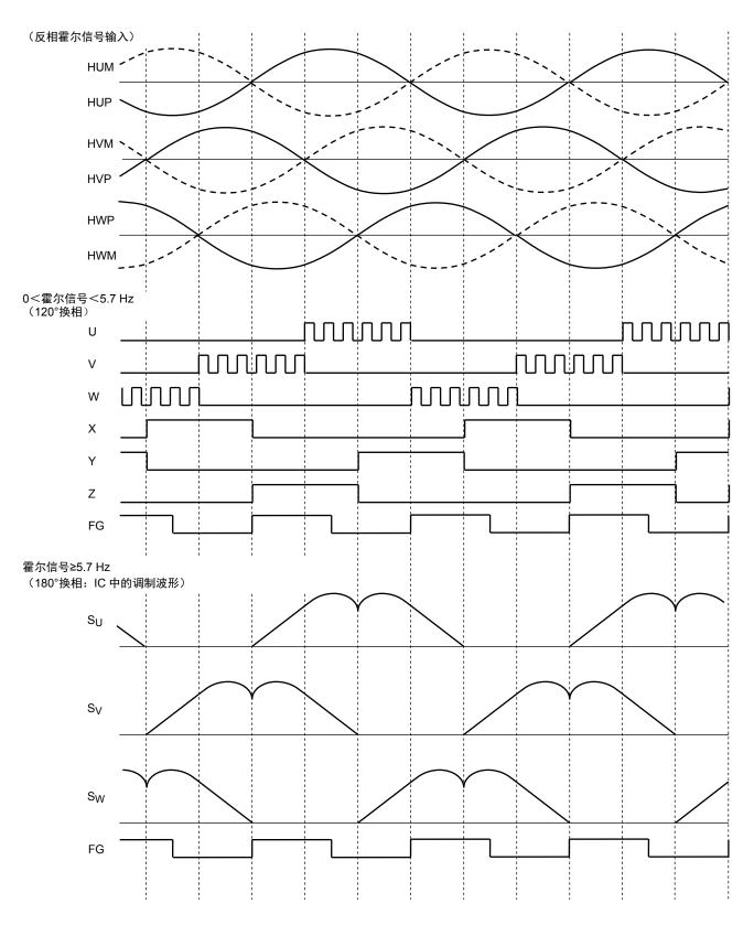
\* 霍尔输入频率为 5.7 Hz 或更高(@ fosc=4.5 MHz)时,将根据 LA 输入激活引导角控制。
