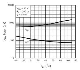
Fig. 16.1.8 t<sub>ON</sub>, t<sub>OFF</sub> - T<sub>a</sub>
