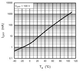
Fig. 16.1.9 I<sub>OFF</sub> - T<sub>a</sub>
