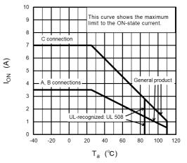
Fig. 16.1.2 I<sub>ON</sub> - T<sub>a</sub>
