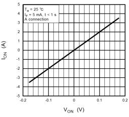
Fig. 16.1.4 I<sub>ON</sub> - V<sub>ON</sub>
