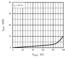
Fig. 16.1.10 I<sub>OFF</sub> - V<sub>OFF</sub>
