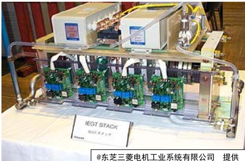
图 5.4 压接式器件固定到水冷式散热片上的实例
