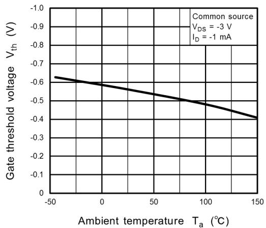
**Fig. 8.6  $V_{th} - T_a$**
