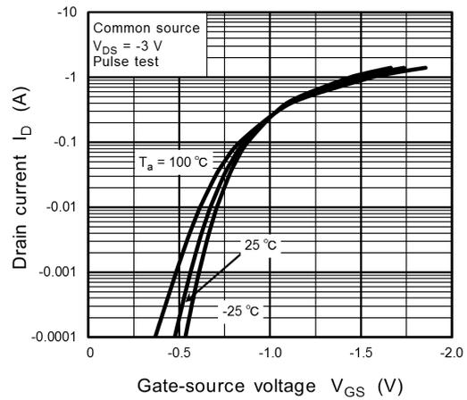
**Fig. 8.2  $I_D - V_{GS}$**
