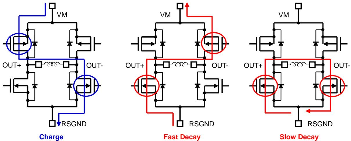
※ 出力切り替わりのタイミングで貫通電流防止時間(400 ns(設計値))が発生します。
