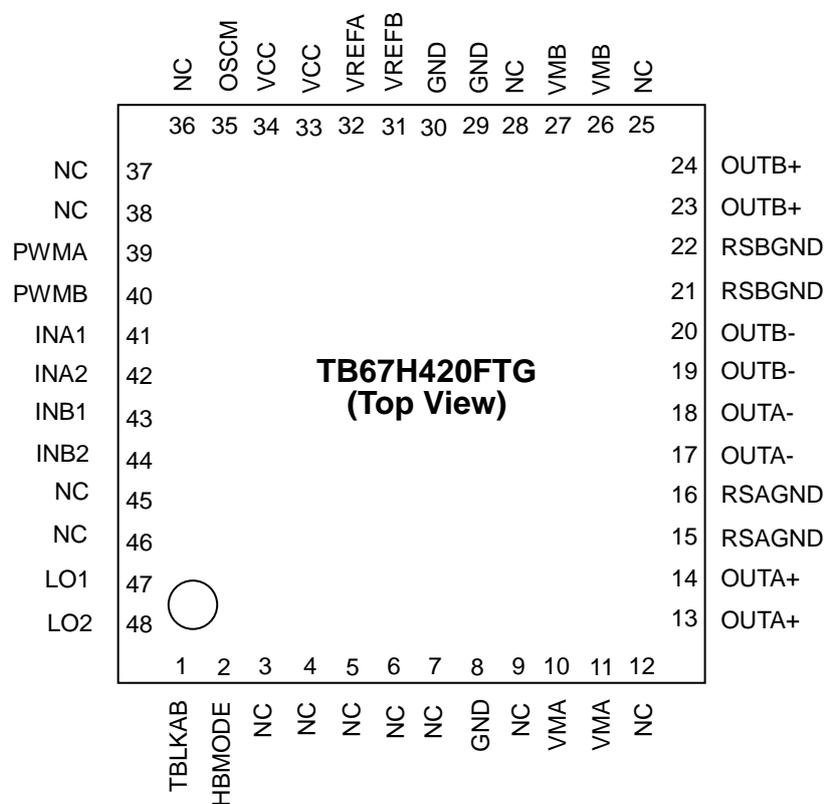
注: QFN パッケージのコーナ PAD および裏面放熱 PAD は必ず基板の GND に接続しご使用ください。
