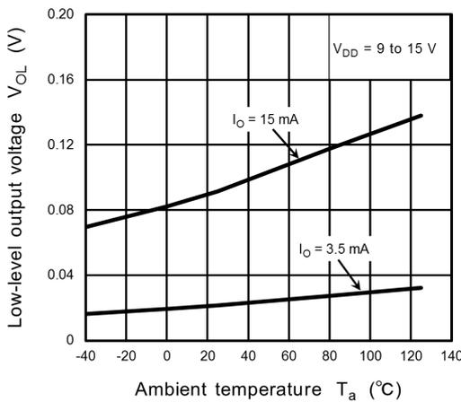
**Fig. 12.2.5  $V_{OL} - T_a$**
