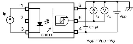
Fig. 12.1.2 VOH Test Circuit
