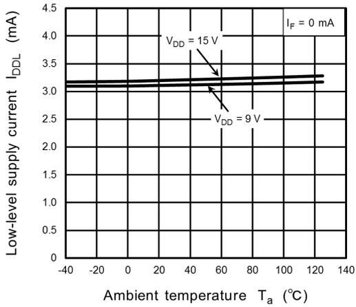
**Fig. 12.2.7**  $I_{DDL} - T_a$
