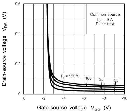
Fig. 8.5  $V_{DS} - V_{GS}$
