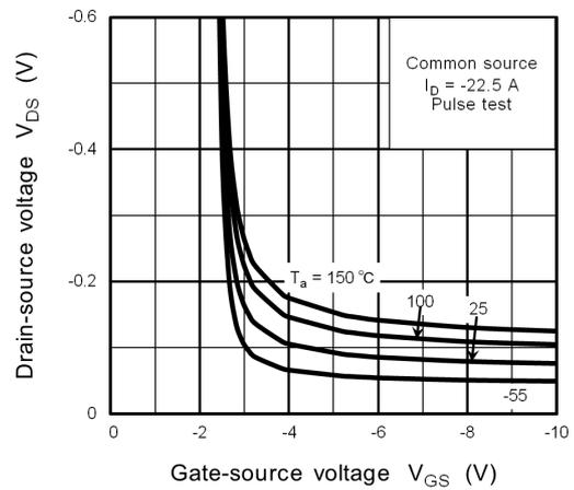
Fig. 8.4  $V_{DS} - V_{GS}$
