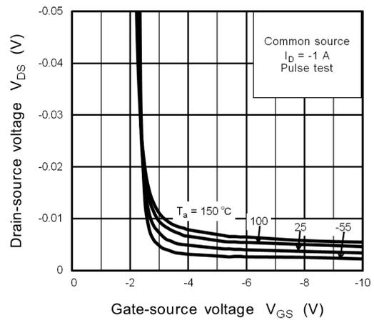
Fig. 8.6  $V_{DS} - V_{GS}$
