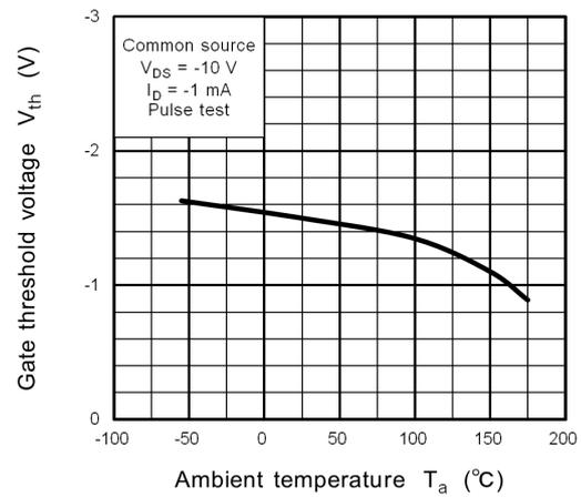
**Fig. 8.12  $V_{th} - T_a$**
