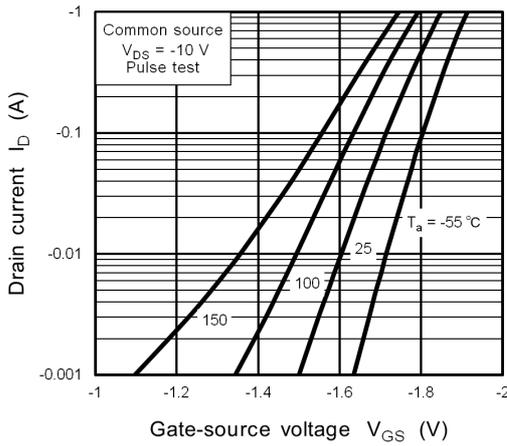
**Fig. 8.7  $I_D - V_{GS}$**
