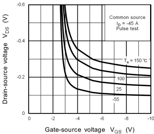
Fig. 8.3  $V_{DS} - V_{GS}$
